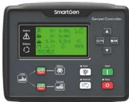
**PANEL DE CONTROL PARA GENERADOR CON ACCESO REMOTO VÍA 4G**
